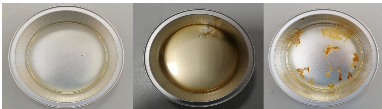
Figura 24. Materiale mcl -PHA estratto, come si presenta dopo l'essiccamento in stufa. (SX estrazione con cloroformio; CENTRO estrazione con ciclopentanone; DX estrazione con acetone).
