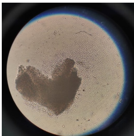
Figura 10. Granuli di PHA compattati in un unico granulo per il processo di estrazione; le sfere bianche traslucide sono cellule batteriche che stanno degradando il granulo di PHA.
