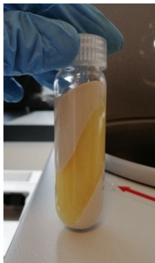
Figura 22. È possibile distinguere le tre fasi ottenute a seguito della centrifugazione del brodo di fermentazione di P. putida . La fase inferiore e superiore hanno colorazione e morfologia simile, mentre quella intermedia di surnatante è di consistenza acquosa e di colore giallo.
