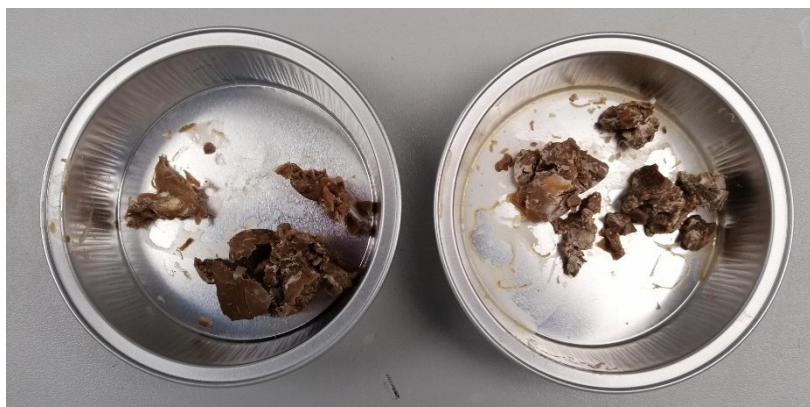
Figura 16. Materiale di PHBv, dopo l'essiccamento in stufa. (SX prova A; DX prova B)
