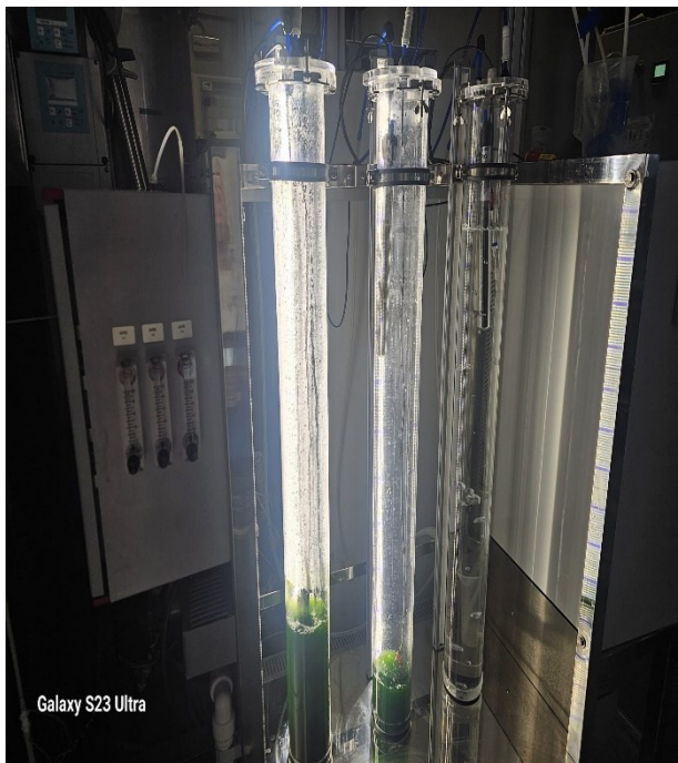
Figura 2.7 - Bioreattori tubolari in acrilico (Aqualgae, Spagna).
