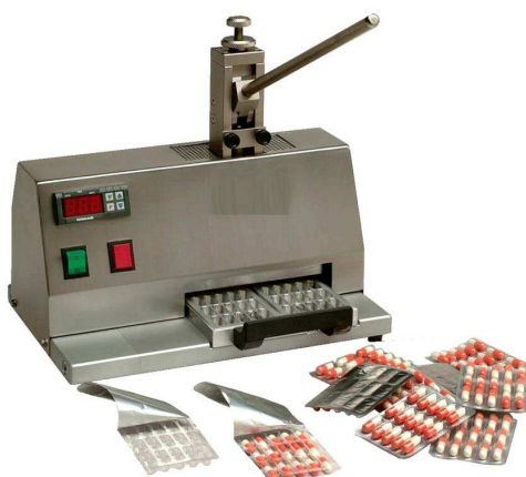
Figura 4. Blisteratrice manuale impiegata nel processo di deblistering per la rimozione delle unità farmaceutiche dal confezionamento primario, mediante applicazione di una pressione meccanica controllata. Cheimika , https://www.cheimika.it/it-IT/articoli/Blisteratrice-manuale--8647.aspx
