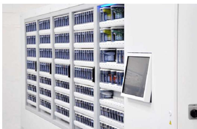
Figura 5. Sistema automatizzato Smart Dose utilizzato per il deblistering, controllo qualità dei medicinali e riconfezionamento personalizzato. Fonte: https://rowa.de/it
