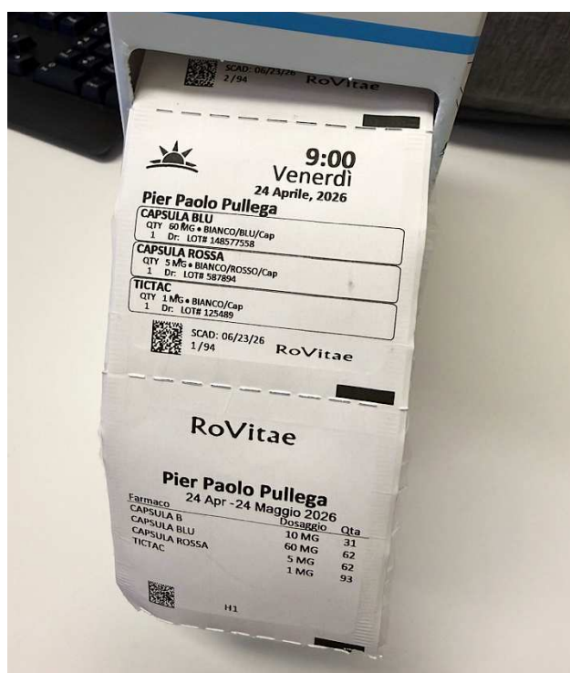
Figura 12 Blister personalizzato con etichettatura creata dal software e apposta dal macchinario. Fonte: Mekasafe srl, Dott.ssa Laila Tindara Raffaele.
