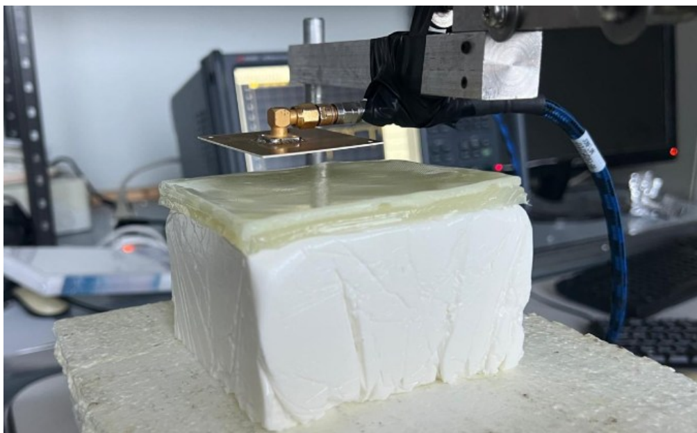
Figura 4.10 – Setup utilizzato per le misure con antenna patch.
