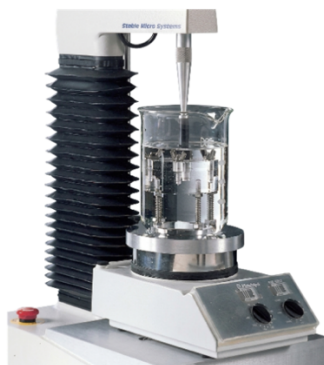
Figura 17: configurazione sperimentale del TA.XT plus Texture Analyser equipaggiato con una cella di bioadesione sommersa (immagine creata con Biorender).
