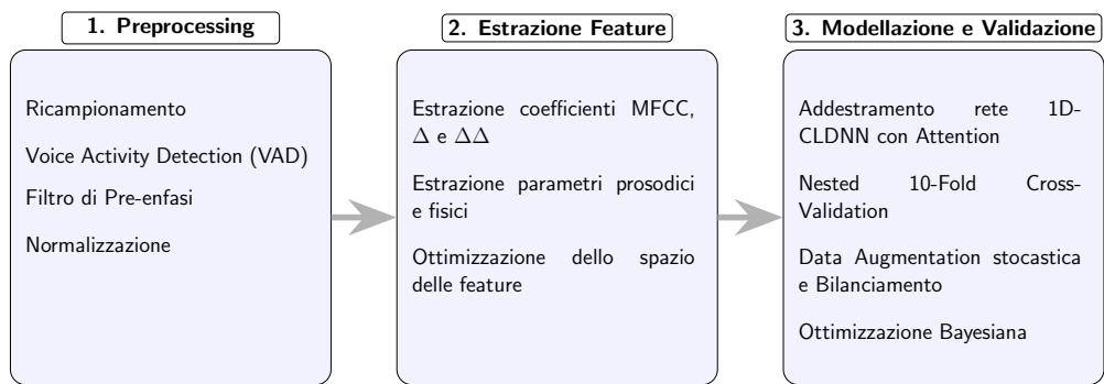
Figura 3.2: Pipeline per il riconoscimento dello stato emotivo implementata in MATLAB.
