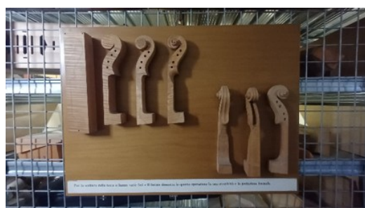
Figura 70: Fasi di lavorazione del ricciolo
