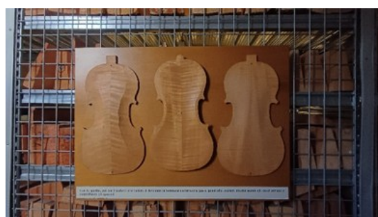
Figura 65: Fasi della bombatura del fondo
