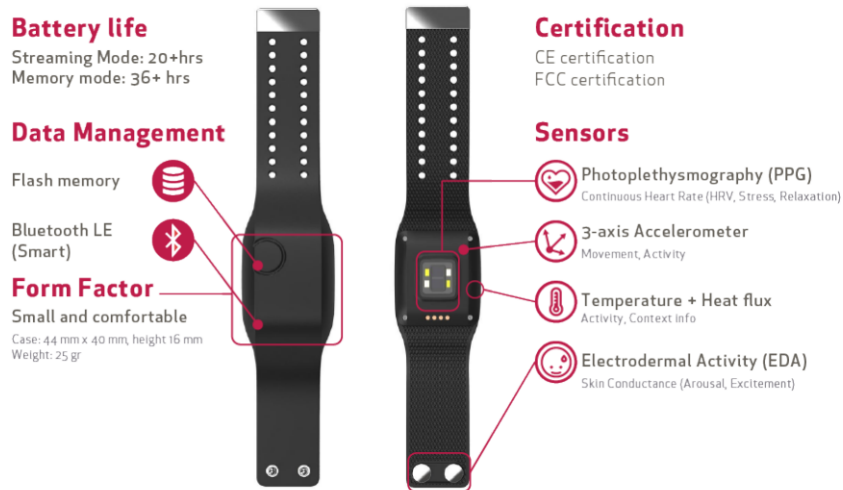
Figura 4.1: Panoramica dell'hardware, dei sensori integrati e delle specifiche tecniche del bracciale Empatica E4. Immagine estratta dalle specifiche tecniche ufficiali (Fonte:Empatica S.r.l.[46]).
