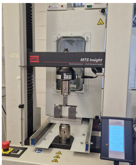
FIGURA 6.22: Configurazione della macchina di prova per la flessione a tre punti
