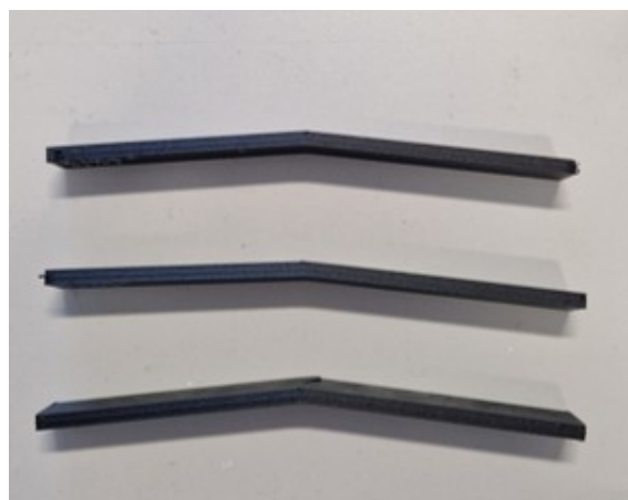
FIGURA 7.23: Patch realizzati in carbonio dopo la prova di flessione a tre punti (vista laterale)
