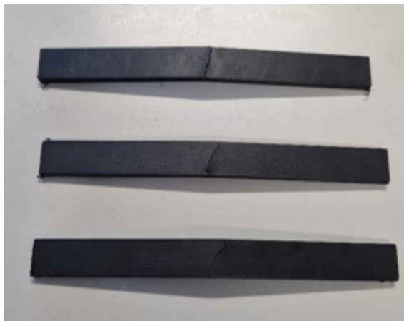
FIGURA 7.24: Patch realizzati in carbonio dopo la prova di flessione a tre punti, con l'evidente rottura nella parte superiore
