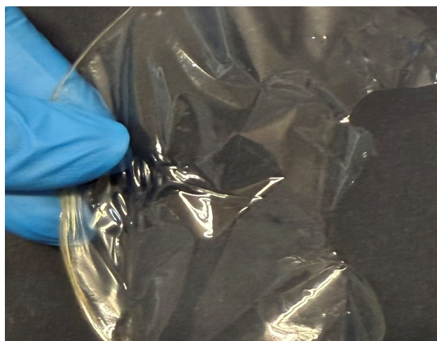
Figura 10. immagine del prodotto della sintesi del film Ca-Alg-PVA
