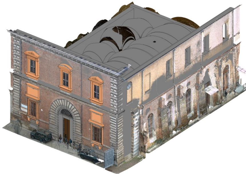
Figura 8.14. Il modello integrato con la nuvola: il complesso visto da sud-ovest, con i muri perimetrali misurati e le aperture che li tagliano, le diciotto vele a sesto variabile e la nuvola accesa che riempie le parti non modellate.
