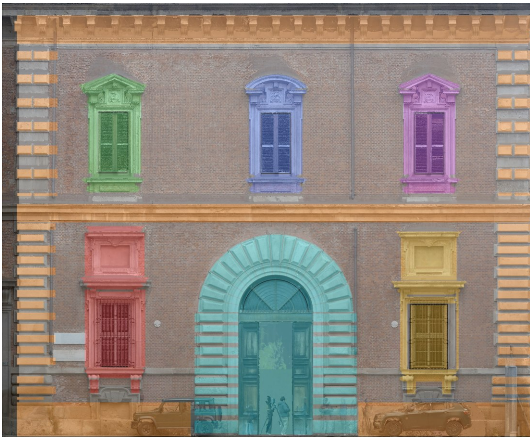
Figura 9.8. Mappa degli identificativi: le geometrie delle otto famiglie del fronte ovest riproiettate con z-buffer sulla griglia dell'ortoimmagine, un colore per elemento; ogni pixel è attribuito all'elemento del modello che lo occupa.
