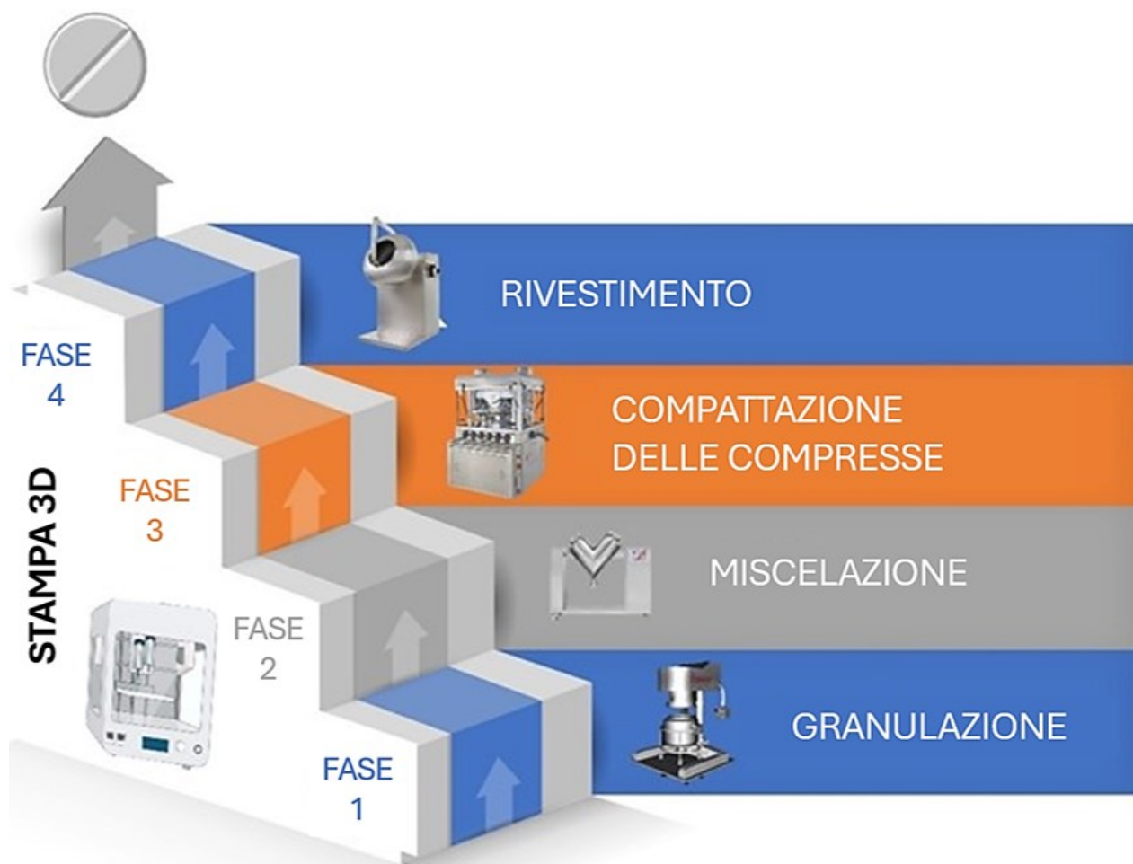
Figura 14 - Confronto tra il processo tradizionale di produzione delle forme farmaceutiche solide, che comprende le fasi di granulazione, miscelazione, compressione e rivestimento, e la stampa 3D, che consente di ottenere il prodotto finale attraverso un processo più diretto e personalizzabile. Immagine tratta e adattata da Serrano et al., 2023 [50].
