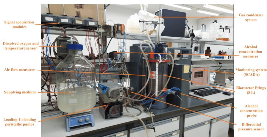
Figura 6: Esempio di un impianto pilota su scala di laboratorio dotato di un bioreattore Frings (8 L) che funziona in modalità fed-batch e di un sistema di automazione SCADA che controlla le principali variabili del sistema. Laboratorio di ingegneria biochimica, sezione di ingegneria chimica, Università di Córdoba, Spagna. 2
