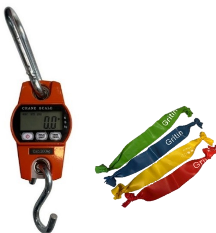
Figura 2.7: Dinamometro digitale usato per la misurazione delle resistenze di ciascuna banda elastica e rispettive bande elastiche utilizzate
