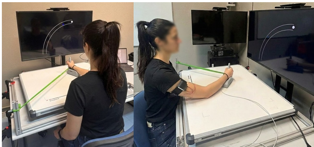
Figura 2.2: Apparato sperimentale utilizzato per l'esecuzione del compito motorio tramite tavoletta digitalizzatrice CalComp. Un elastico è vincolato a un vertice della tavoletta, sulla quale il soggetto compie movimenti di flessione-estensione sul piano orizzontale.
