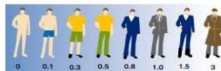
Figura 34 - Impedenza termica del vestiario UNI EN ISO 9920/2004
