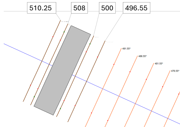
Figura 4.30: Posizioni delle sezioni nell'intorno del ponte, iterazione 1
