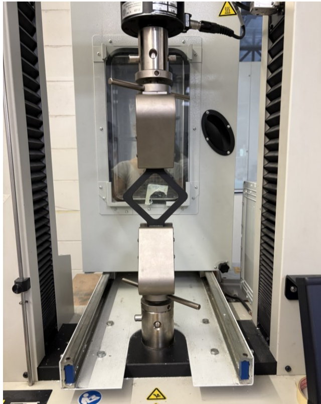
Figure 6.36: Setup della prova di trazione.
