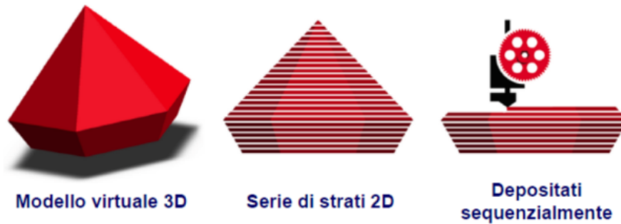
Figure 1.3: Sintesi del processo di manifattura additiva.
