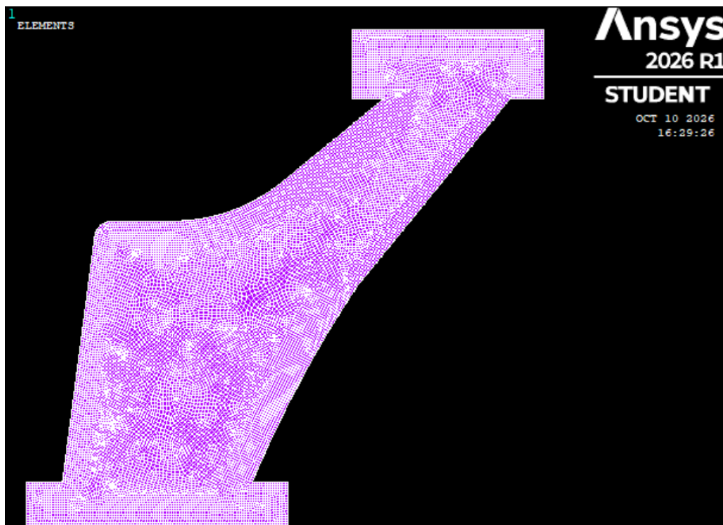
Figure 7.19: Geometria discretizzata in ANSYS APDL.
