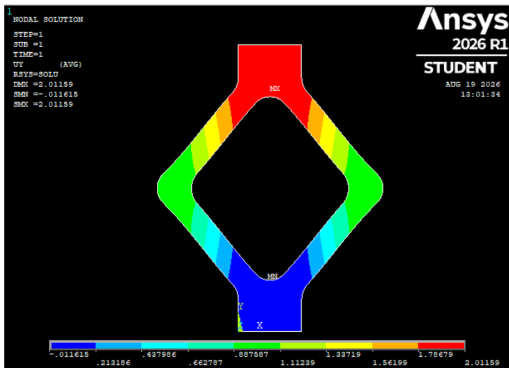
Figure 6.3: Plot dello spostamento in direzione y della geometria.
