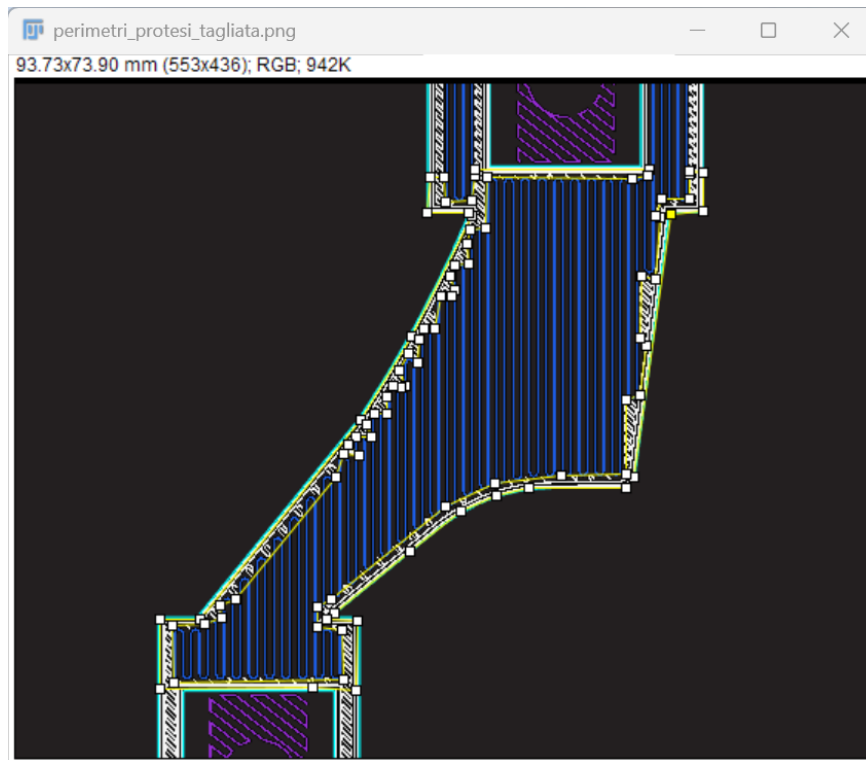
Figure 7.23: Aree di Onyx all'interno del layer di carbonio individuate con ImageJ.
