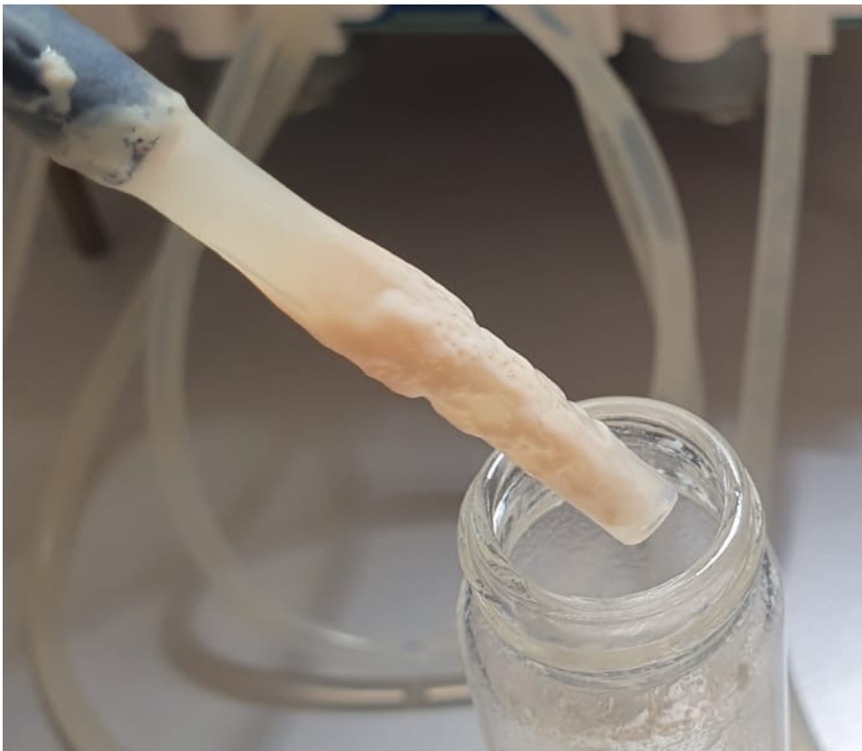
Figura 4.16: Biofilm adeso al pescante in silicone con cui è allungato il tappo di Chi.Bio, foto di differenti esperimenti.
