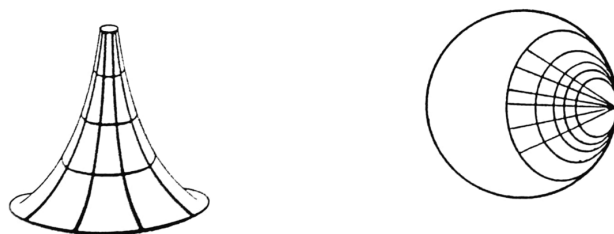
Figura 3.6 Superficie pseudosferica di tipo parabolico e corrispondenti circonferenze geodetiche con centro all'infinito.
