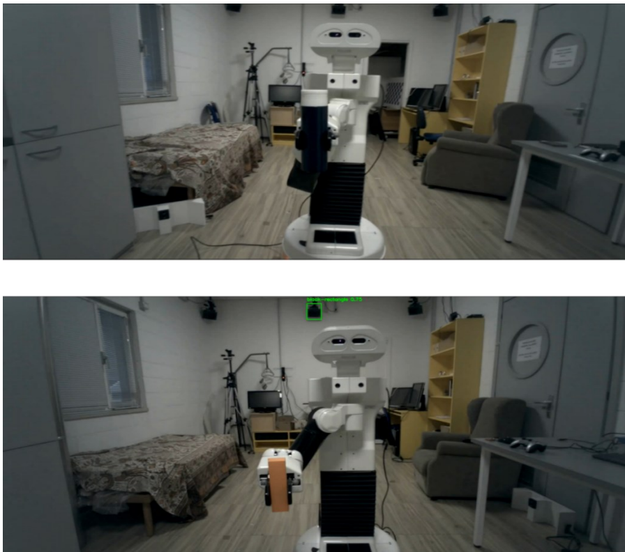
Figura 4.12: Esempi di errori commessi dal Modello 2 durante la valutazione sulle acquisizioni di Testing: mancato rilevamento di una bottle (in alto) e classificazione errata di un orange_block come black-rectangle (in basso).
