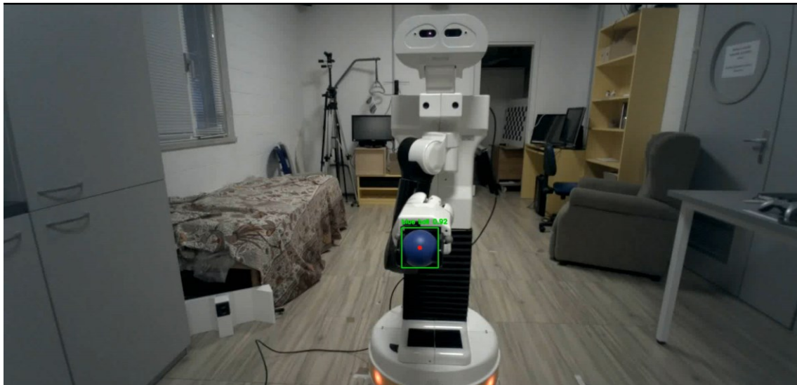
Figura 4.9: Frame di output della rete YOLO con visualizzazione della bounding box associata al target rilevato.
