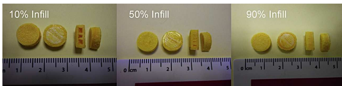
Figura 11. Immagini di compresse ottenute mediante stampa 3D con differenti percentuali di riempimento interno ( infill : 10%, 50% e 90%), che mostrano (da sinistra a destra: vista dall'alto, dalla base, interna e laterale). 99
