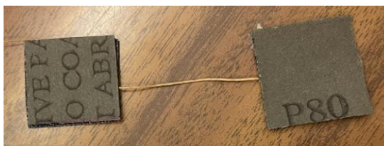
Figura 4.8. Metodologia operativa scelta per la preparazione delle fibre: le estremità vengono fissate tra due foglietti di carta vetrata utilizzando colla istantanea.
