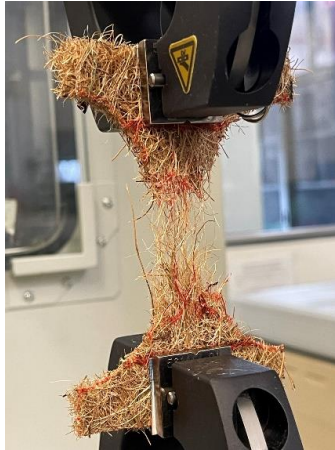
Figura 5.18. Esempio di corretta rottura di un provino al termine del test di trazione.
