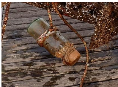
Figura 4.5. Esempio di recipiente utilizzato per il trattamento di immersione in mare delle fibre di cocco estratte dal geotessile.
