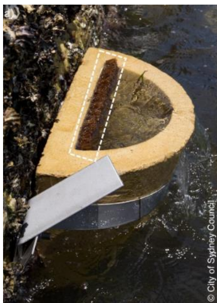
Figura 2.15. Esempio di struttura sperimentale per reclutamento di biofouling, il riquadro tratteggiato indica la posizione del pannello in fibra di cocco (immagine da Morris et al. , 2018).
