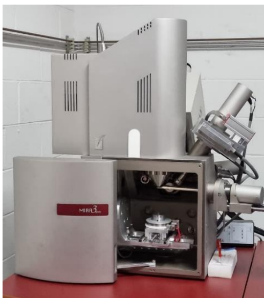
Figura 4.7. Fotografia scattata presso il Laboratorio Arvedi del Laboratorio Arvedi del Centro Interdipartimentale di Studi e Ricerche per la Conservazione del patrimonio culturale (CISRiC) dell’Università di Pavia che mostra il microscopio elettronico a scansione utilizzato per l’analisi superficiale delle fibre.
