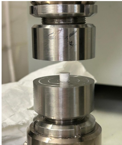
Figura 19. Provino cilindrico di cemento con frattura a seguito della prova di compressione
