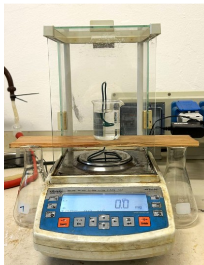
Figura 16. Sistema impiegato per ricavare la densità apparente dei provini di cemento
