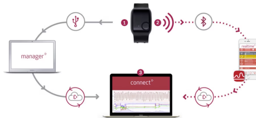
Figura 3.1: Architettura del sistema Empatica E4: il dispositivo (1) trasmette i segnali via bluetooth (2) all'applicazione mobile, che li carica sul cloud Empatica Connect (3) per la successiva esportazione e analisi. Immagine tratta da Empatica Inc.
