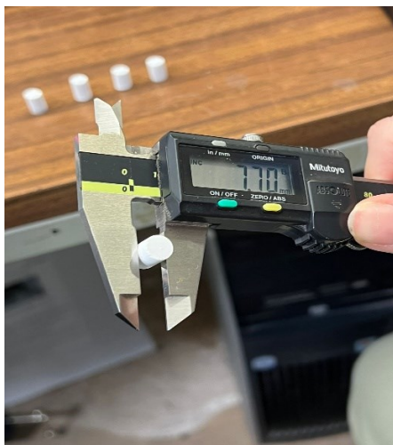
Figura 13: misurazione di un provino cementizio con il calibro
