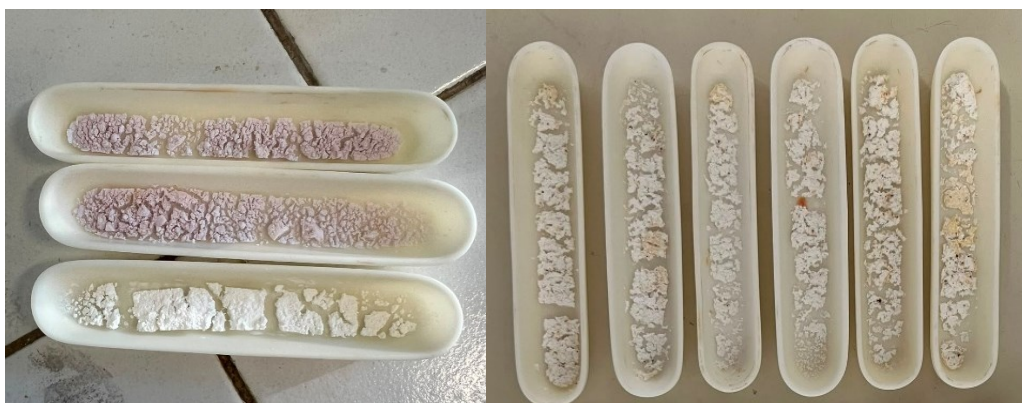
Figura 5: navicelle di allumina contenenti TMP dalla sintesi 2 con colorazioni anomale
