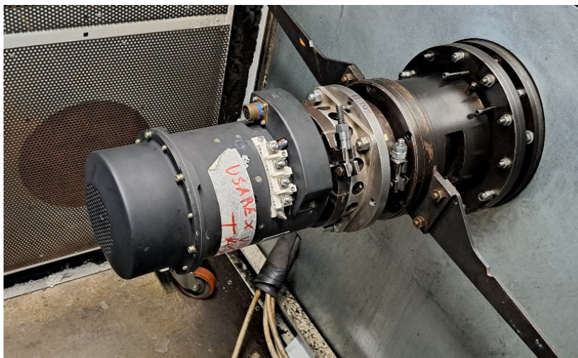
Figura 23: Generatore accoppiato al drive bench
