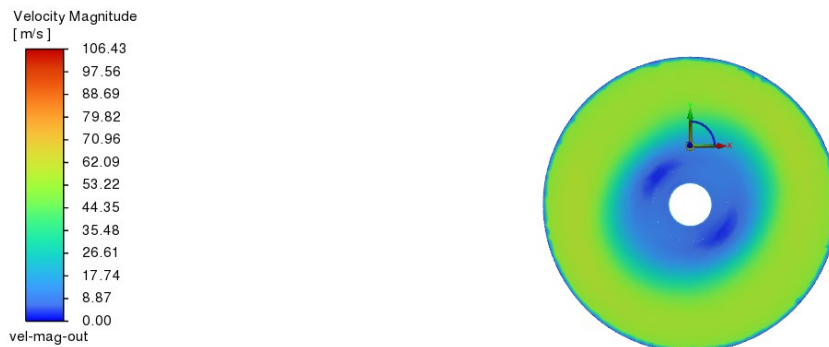
Figura 34: Modulo della velocità nella posizione del secondo tubo di Pitot per il modello con condotto al 50%
