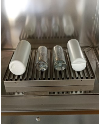
Figura 21: disposizione dei campioni all'interno del Suntest XLS+ di Atlas
