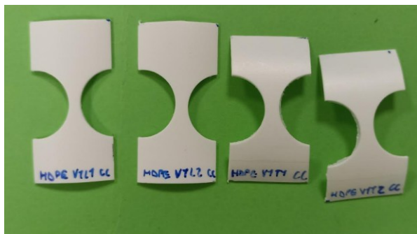
Figura 25: campioni realizzati con la prima fustellatrice
