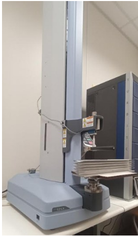
Figura 29: Tensile EZ-LX equipaggiato con tubo specifico
