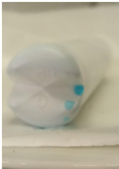
Figura 37: prova di sottovuoto con colorante per dimostrare la perdita del campione S-T1
