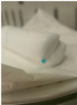
Figura 34: prova di sottovuoto con colorante per dimostrare la perdita del campione S-T0
