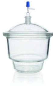
Figura 14: Essiccatore vetro Duran DN 300. [52]
