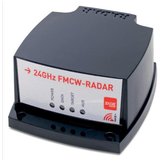
Figura 12: Modulo radar FMCW IMST sentire™ DK-sR-1200 utilizzato nelle acquisizioni sperimentali operante a 24 GHz [23]
