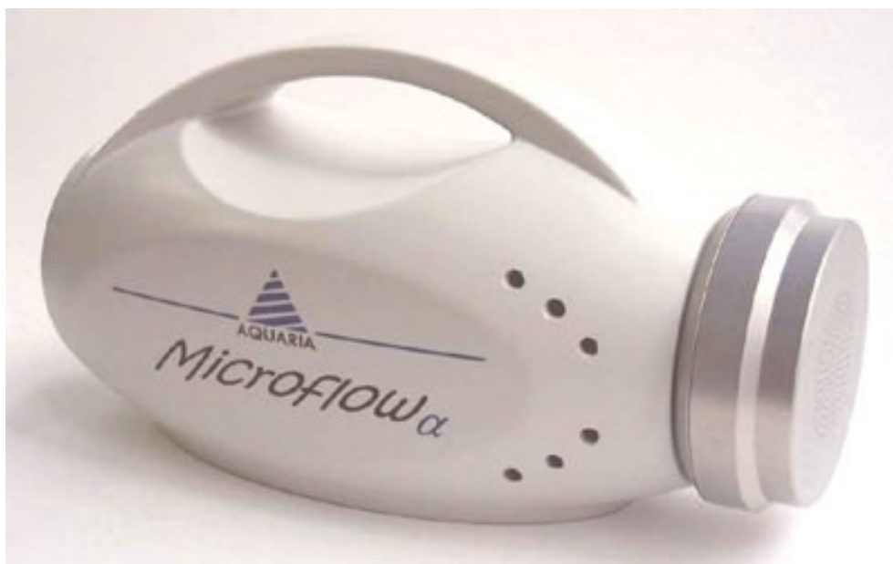
Figura 5: campionatore monostadio ad impatto ortogonale (surface air system, SAS).
