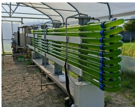
Figura 1. Fotobioreattore MHT (multi tubular horizontal) presso Istituto Sperimentale Italiano Lazzaro Spallanzani
