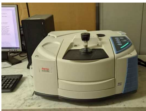
Figura 2.4: Spettrometro Thermo Scientific Nicolet iS20.
