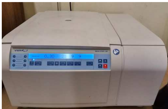
Figura 2.6: Centrifuga da banco refrigerata VWR Mega Star 1.6R utilizzata per la ripartizione dei campioni.
