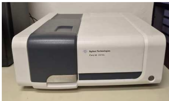
Figura 2.8: Spettrometro Agilent Cary 60 UV-Vis utilizzato per le caratterizzazioni ottiche dei campioni.
