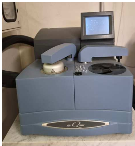
Figura 2.9: Calorimetro differenziale a scansione (DSC) modello Q2000 della TA Instruments.
