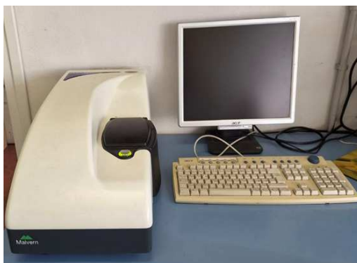
Figura 2.3: Strumento Malvern Zetasizer Nano utilizzato per le analisi di DLS.
