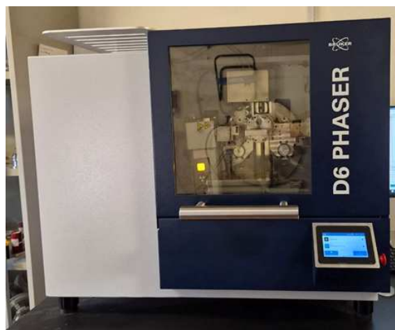
Figura 2.5: Diffrattometro a raggi X da banco Bruker D6 PHASER utilizzato per la caratterizzazione dei campioni in polvere.
