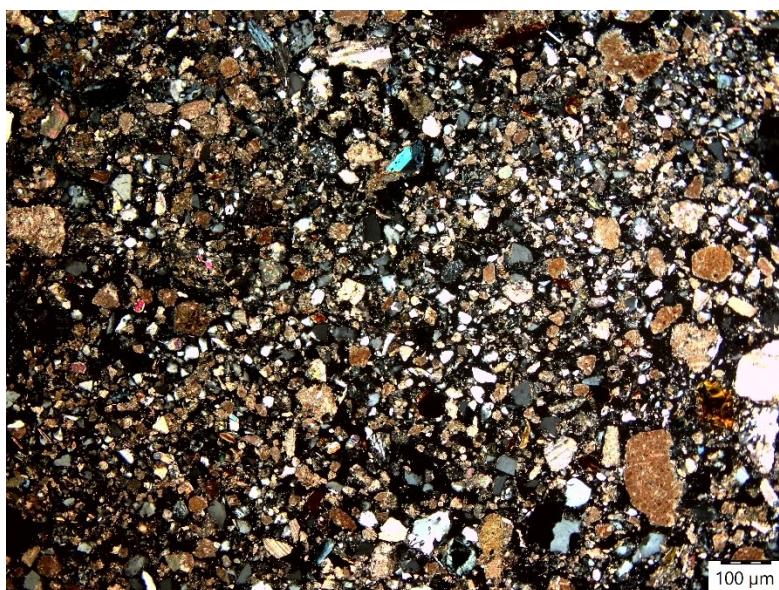
Figure 2.20 : fotografia sezione sottile di sabbie del fiume Curone, rappresentativa della composizione degli affluenti appenninici del Po; campione CUtot al 4X a nicol incrociati.
