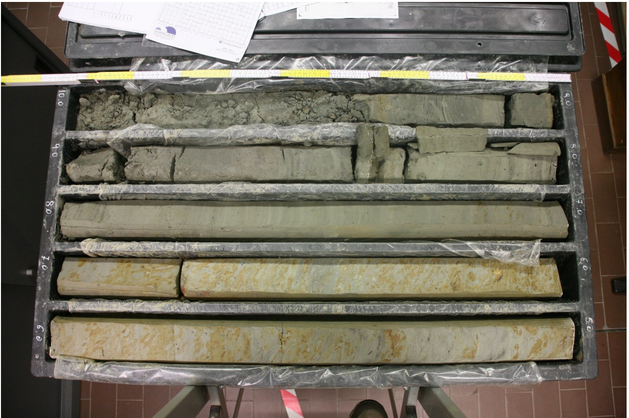
Figura 3: Carote ottenute dal nuovo sondaggio CARG Pavia 160 (5-10 m)
