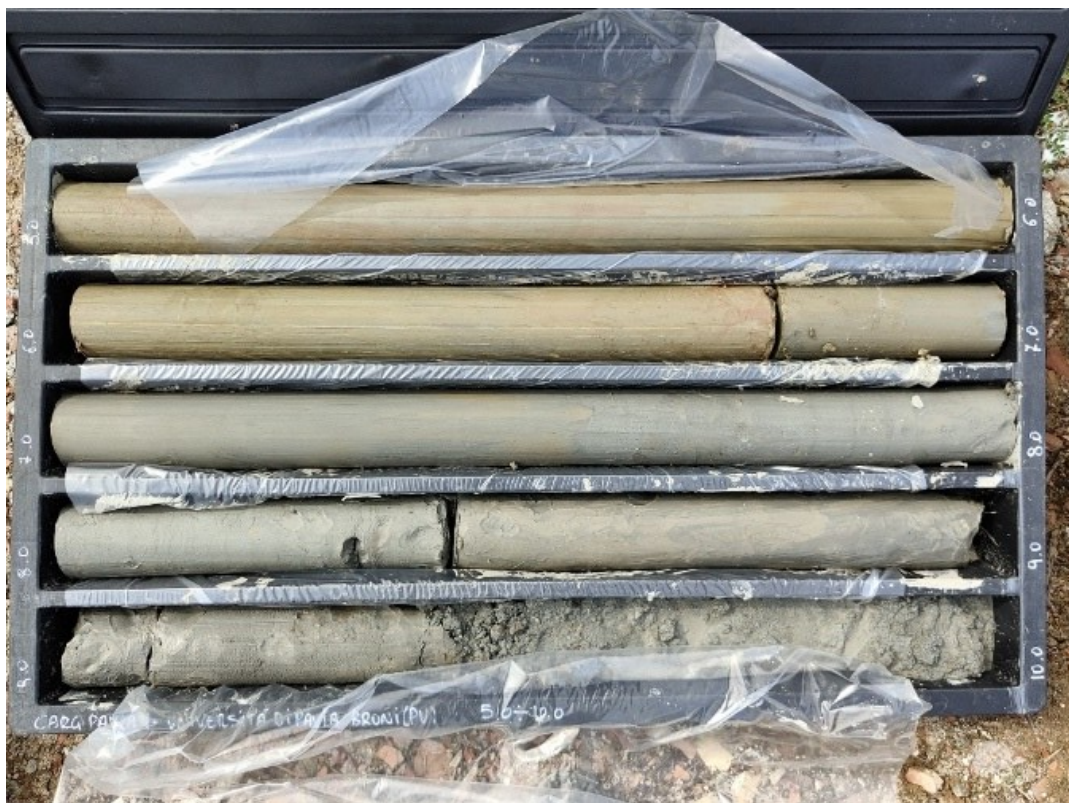
Figura 3.3: Esempio di carota posta in cassette catalogatrici.
