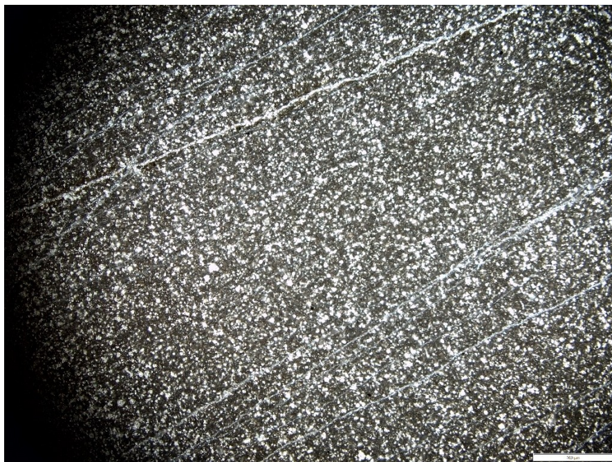
Figura 4.62: Campione CPI-C13.8 del sondaggio CARG Pavia 160 a nicol // (calcare a grana fine a radiolari).
