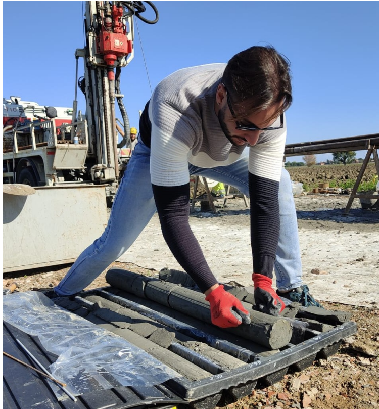
Figure 3.4: Divisione delle carote per mostrare stratificazioni.
