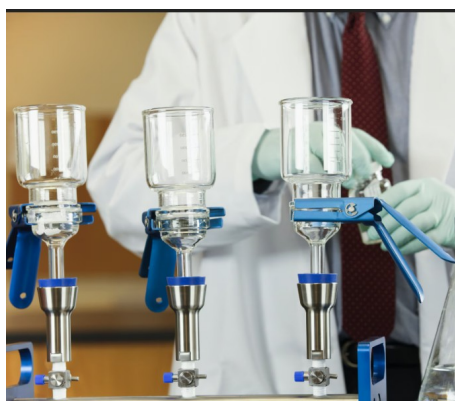
Figura 3.1: Sistema di filtrazione delle acque.
