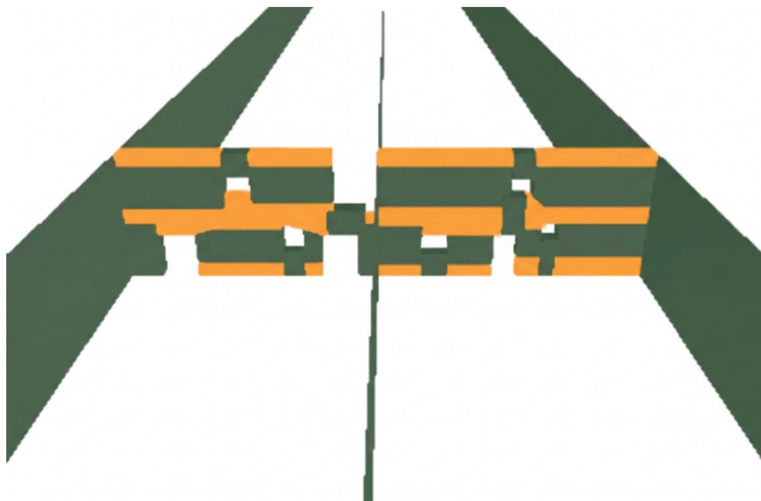
Figura 9.20 Visualizzazione del modello numerico con le flange ortogonali in evidenza
