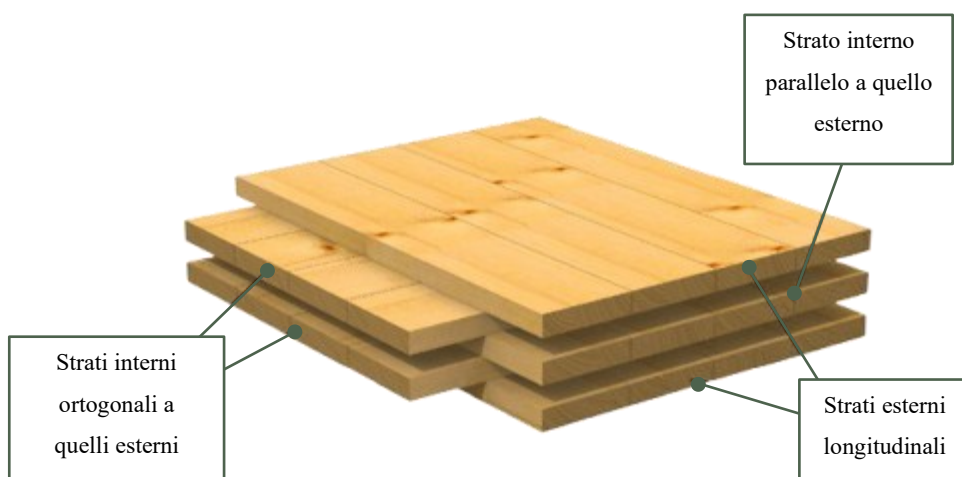
Figura 10.1 Rappresentazione schematica della tecnologia XLAM [39]
