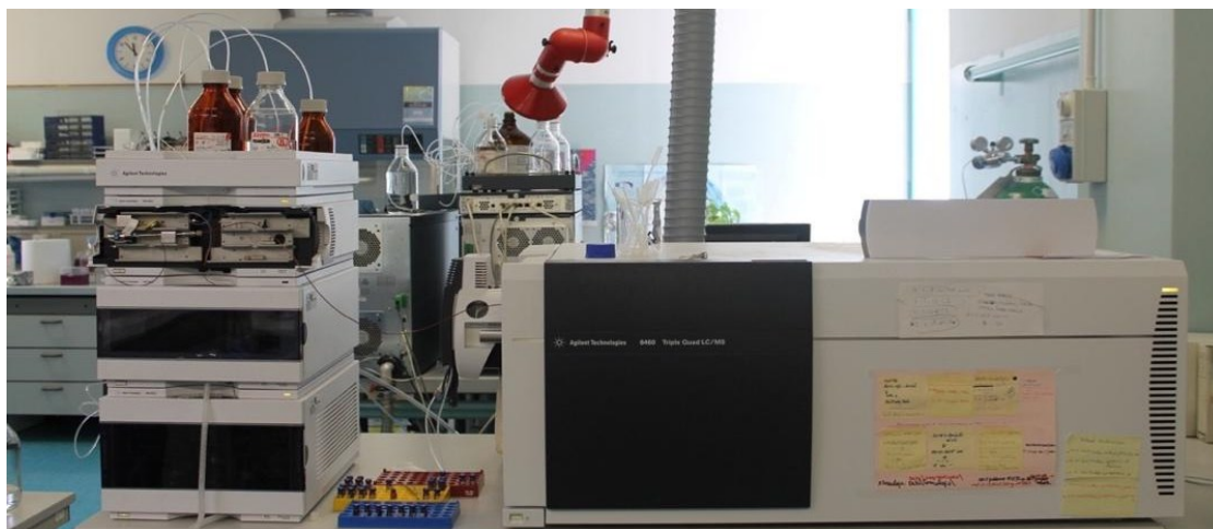
Figura 3: Sistema UHPLC-MS/MS utilizzato per l'analisi degli analiti
