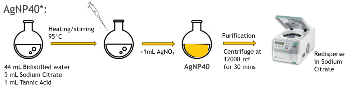
Figura 4 Schema della procedura di sintesi per AgNP40* adattato da (17)
