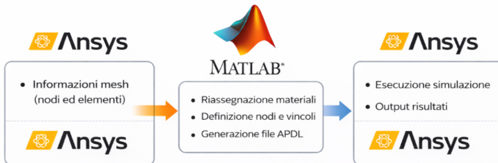
Figura 4.11: Workflow automatico per la preparazione del modello, la riassegnazione dei materiali e l'esecuzione della simulazione strutturale.
