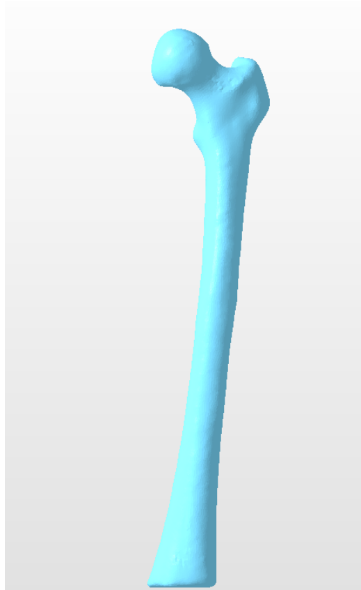
Figura 4.2: Modello finale del femore dopo operazioni di smoothing e post-processing in ambiente Netfabb.
