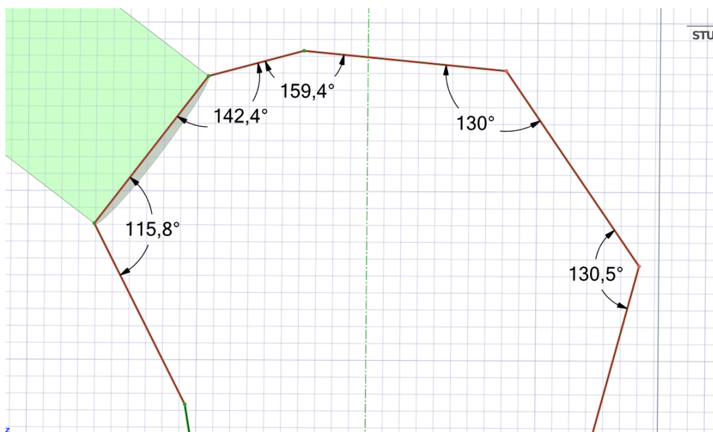
Figura 4.18: Dettaglio del profilo geometrico nella regione prossimale della protesi, con evidenza degli angoli caratteristici che definiscono i raccordi tra i tratti rettilinei.
