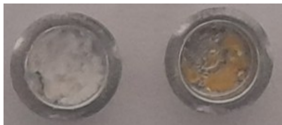
Fig. 3.18: DRtq (sinistra) e DRtq dopo riscaldamento fino a 173 °C (destra).
