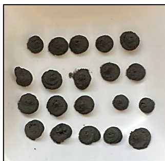
Figura 26. Foto dei catalizzatori CoO slurry . Creati tramite robocasting
