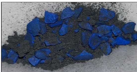
Figura 14. Foto del campione CoO supportato su Al 2 O 3 commerciale, ottenuto tramite sintesi sol-gel, a seguito del trattamento termico di calcinazione a 1000 °C per 12 ore.
