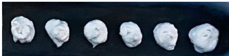
Figura 35. Supporti di \text{Al}_2\text{O}_3 ottenuti per estrusione manuale dello slurry
