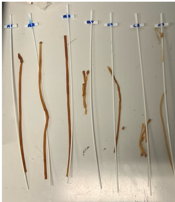
Figura 3.3.1.4: Confronto tra tubi in lattice ottenuti mediante dipping all'inizio dell'attività sperimentale: i tre campioni a sinistra, realizzati con lattice puro (TSC: 60,5%), risultano integri, mentre gli altri campioni, ottenuti con lattice diluito (TSC: 50%), si sono rotti in fase di sfilamento a causa del ridotto spessore del film
