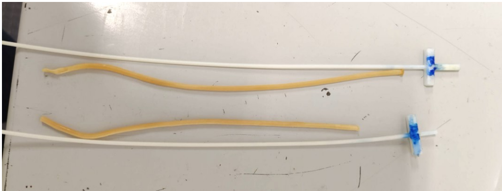
Figura 3.3.1.5: Tubi in lattice ottenuti mediante procedura di dipping B (immersione in soluzione coagulante a base di nitrato di calcio, seguita da asciugatura e successiva immersione nel lattice puro)
