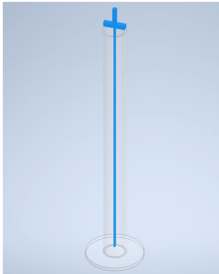
Figura 3.3.1.3: Disegno CAD dell'assembly della vasca di immersione (mostrata in trasparenza) con uno stampo al suo interno
