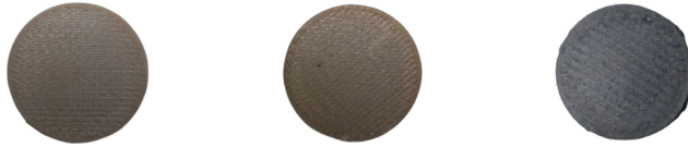
Figura 30 Campioni di PEEK utilizzati nella caratterizzazione. Da sinistra: campione del gruppo G1XX (profilo cristallino), campione del gruppo G3XX (profilo amorfo) e campione del gruppo G4XX (PEEK rinforzato con fibre di carbonio, PEEK-CF). Il campione G1XX presenta una colorazione grigio-beige, mentre il campione G3XX mostra una tonalità più calda tendente al marrone; entrambi i campioni in PEEK puro mostrano la morfologia superficiale a layer tipica del processo FFF visibile sulla faccia superiore. Il campione G4XX si distingue nettamente per la colorazione nera conferita dalle fibre di carbonio disperse nella matrice polimerica.
