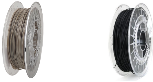
Figura 20 Filamenti termoplastici utilizzati per la stampa FFF dei campioni oggetto di studio. A sinistra: filamento di PEEK puro; a destra: filamento di PEEK rinforzato con fibre di carbonio, PEEK-CF (colore nero).
