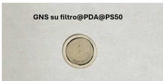
Figura 28: immagine del filtro@PDA caricato con una sospensione di PS50 nm e poi funzionalizzata successivamente con una sospensione di nanostelle.
