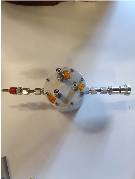
(c) Blocco assemblato. Sono visibili connettori SHV per l'alimentazione degli elettrodi.
