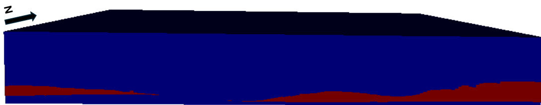
Figura 32: Visualizzazione tridimensionale del Grid 3D (150 x 150 x 200 celle), dimensione cella 100 x 100 x 10m) con il volume delle Ghiaie di Sergnano calcolato nelle fasi precedenti (in rosso).
