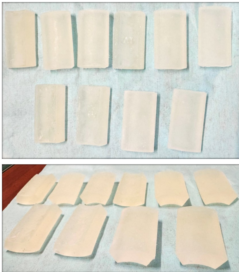
Figura 31: Esempi di campioni multistrato a cinque e quattro strati prima dell'esecuzione della prova di taglio.
