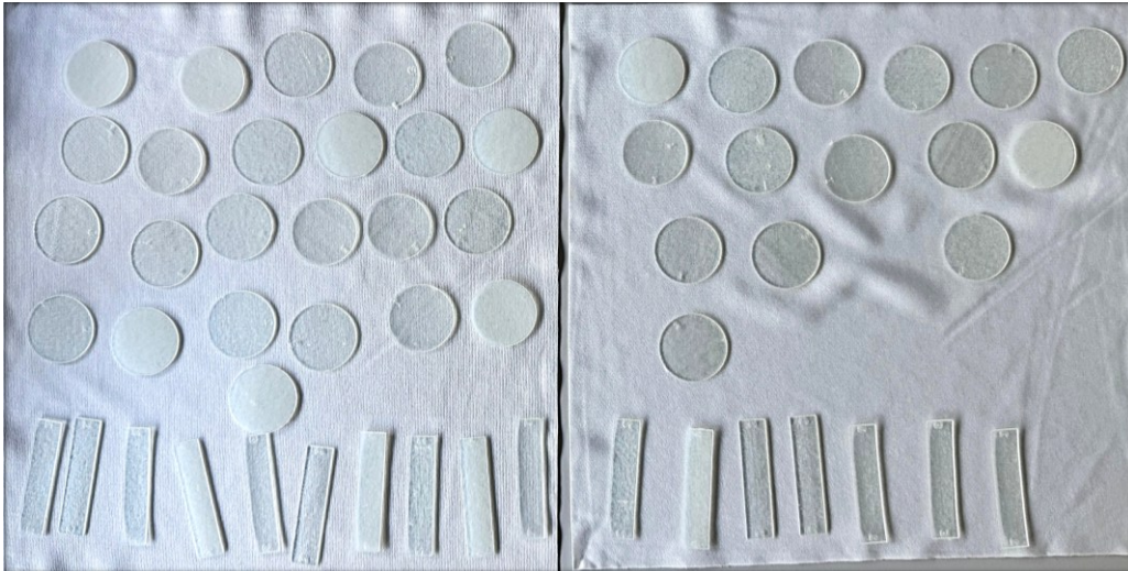
Figura 27: Campioni di cute sintetica al termine del processo di stampa 3D.
