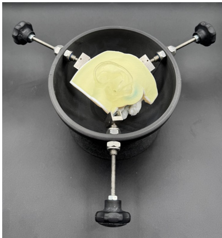
Figura 97: Simulatore finale della regione temporale posizionato su un apposito sistema di fissaggio realizzato mediante stampante metallica SLM.
