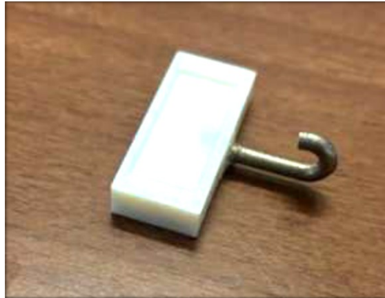
Figura 49: Supporto stampato in 3D per il montaggio dell'uncino nel test di trazione del punto di sutura.
