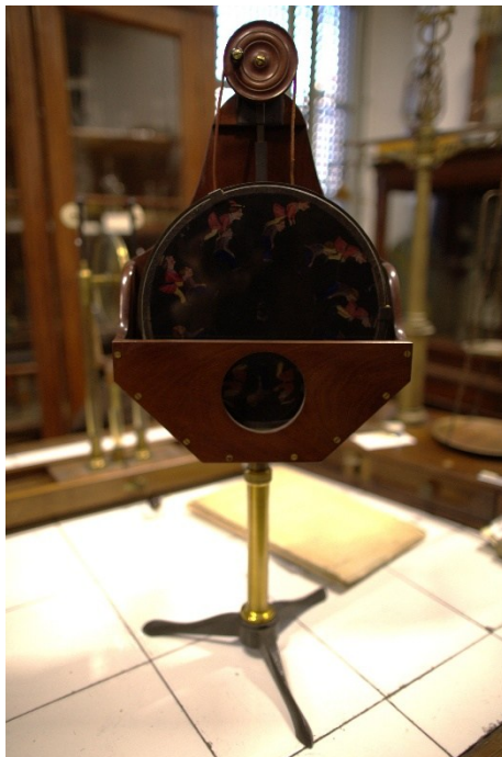
Immagine 13 e 13a Fenachistoscopio da proiezione, davanti e dietro.
