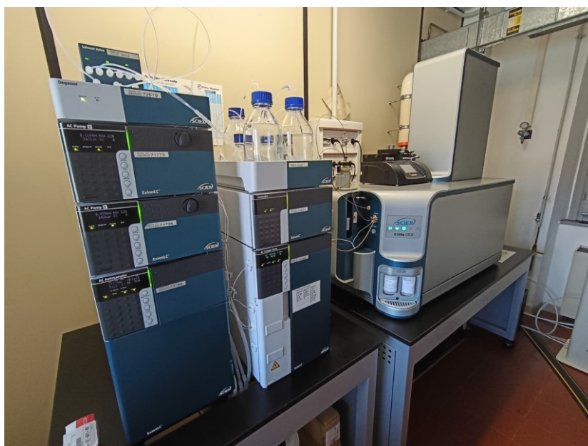
Fig. 3.2.3f: Strumento per l'analisi della massa; a sinistra la parte legata alla cromatografia liquida, a destra la parte legata alla spettrometria di massa (foto scattata da Viviana Casotto durante il laboratorio)
