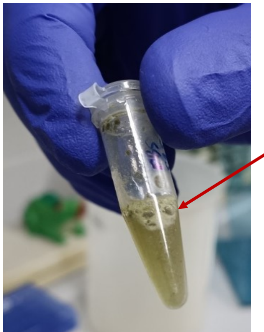
Fig. 4.2.1a: Eppendorf contenente 5mg di Chrysotila roscoffensis in 500 \mu L di HCl, indicate con la freccia rossa sono le bolle di reazione (foto scattata da Viviana Casotto durante il laboratorio)
