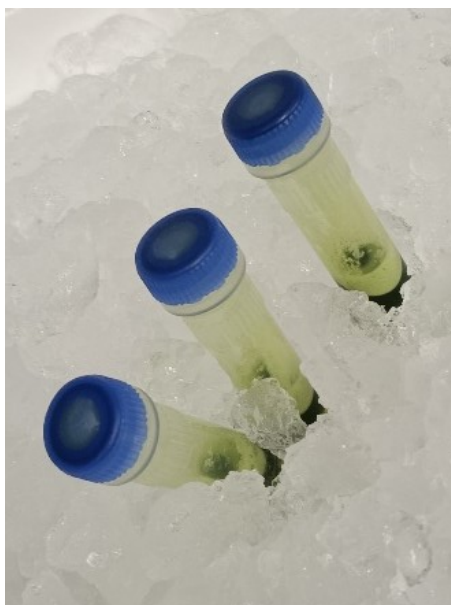
Fig. 3.2.1g: Provette inserite in bagno di ghiaccio per il raffreddamento (foto scattata da Viviana Casotto durante il laboratorio)
