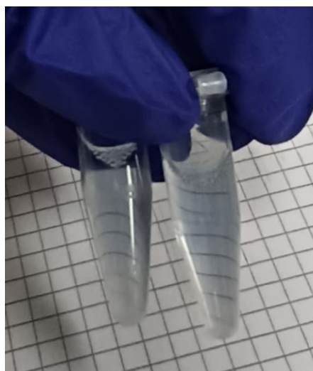
Fig. 4.2.2b: Campioni di Chrysotila roscoffensis pronti per l'analisi spettrofotometrica; a sinistra il campione pretrattato con HCl e a destra il campione tal quale (foto scattata da Viviana Casotto durante il laboratorio)
