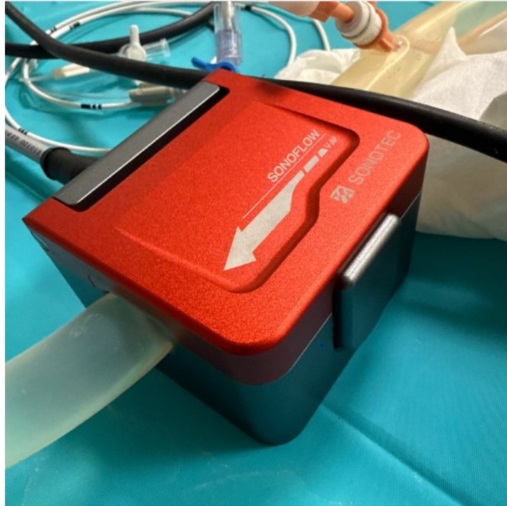
Figura 2.4: Flussimetro a ultrasuoni clamp-on non invasivo applicato al tubo in silicone del circuito sperimentale.
