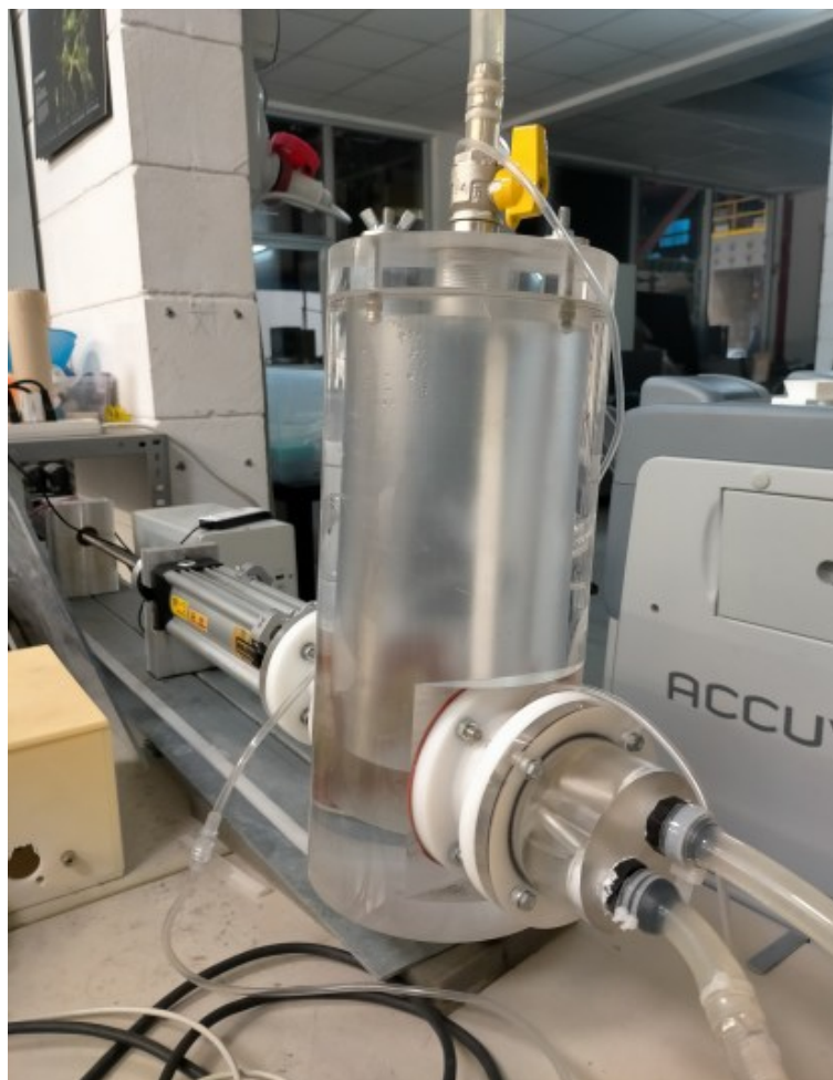
Figura 2.3: Compliance ventricolare del banco prova. Serbatoio elastico riempito di fluido e aria, dotato di valvola superiore per la regolazione del volume d'aria e quindi della rigidità equivalente.
