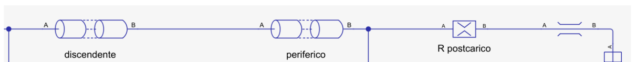
Figure 2.18: Compartimenti del modello rappresentativi dell'aorta discendente, del distretto periferico e del post-carico sistemico terminale.
