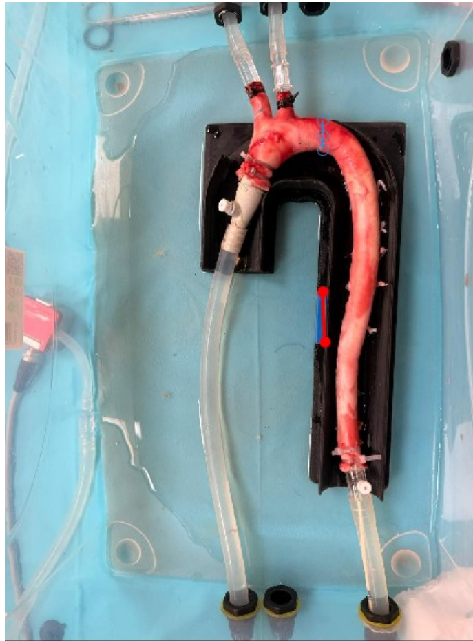
Figura 2.5: Misurazione in regime continuo del diametro dell'aorta discendente a 100 mmHg mediante analisi fotografica calibrata.
