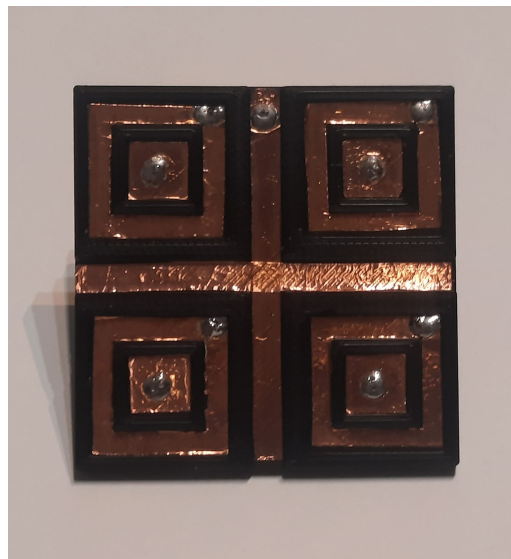
Figura 4.5: Faccia anteriore del supporto in PLA contenente il rame
