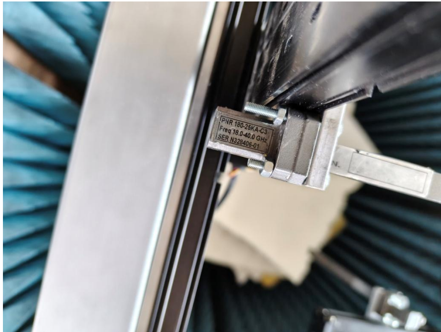
Figura 5.2: Dettaglio della targa identificativa di una delle due antenne impiegate nel setup (modello PNR 180-25KA-C3, range operativo 18.0 - 40.0 GHz).
