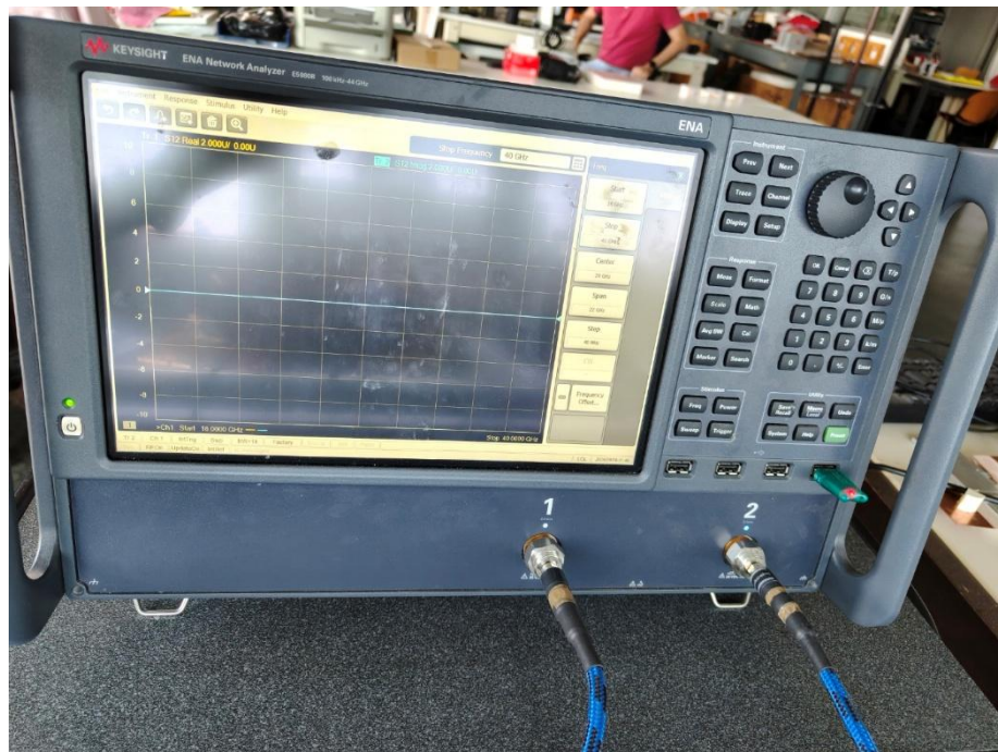
Figura 5.1: L'Analizzatore di Reti Vettoriale Keysight ENA E5080B utilizzato per la generazione e l'acquisizione dei segnali a radiofrequenza nella banda 18-40 GHz.
