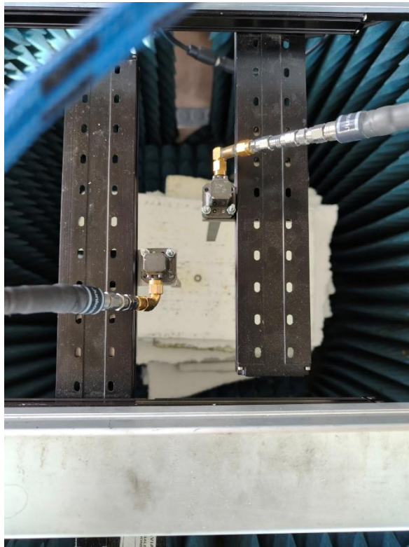
Figura 5.27: Vista dall'alto del setup sperimentale per la quarta misura. Le due rondelle metalliche sono poste a due quote diverse, a circa 8 cm e a circa 6 cm dal piano delle antenne, separate da uno strato di polistirolo.
